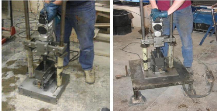
الشكل (18-1) إلى اليسار: استخدام المطرقة الكهربائية. و إلى اليمين: استخدام الرجاج الآلي بالإضافة للمطرقة
