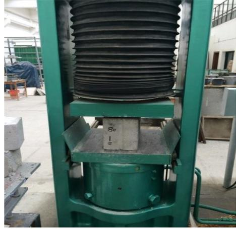
الشكل (3-10) آلية قياس المقاومة على الضغط البسيط لعينات البلوك المفرغ
