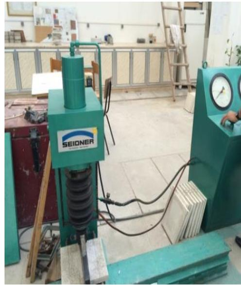
الشكل(3-11) آلية قياس المقاومة على الشد بالانعطاف لعينات بلاط الأرضية الإسمنتي
