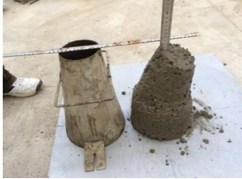
الشكل (2-11) قياس الهبوط بمخروط أبرامز
